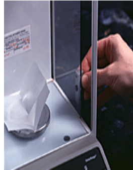
รูปที่ 2.9 แสดงเครื่องชั่งไฟฟ้าแบบละเอียดชนิดจานเดี่ยว
