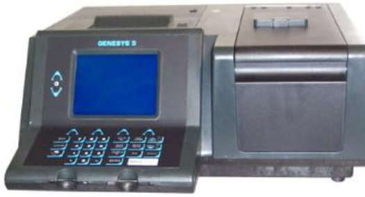
รูปที่ 2.13 แสดงเครื่องวัดค่าการดูดกลืนคลื่นแสงรุ่น Spectronic Genesys 5
