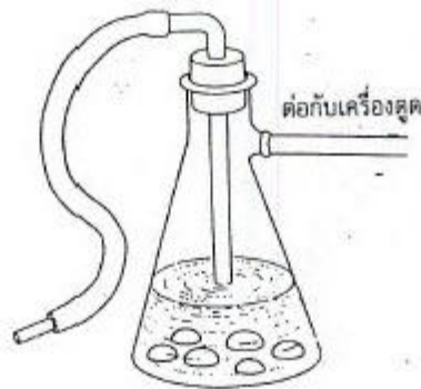
ภาพที่ 1 การเก็บสารปรอทที่หกโดยใช้เครื่องดูด ที่มา ประเสริฐ ศรีไพโรจน์, 2539, เทคนิคทางเคมี, หน้า5
