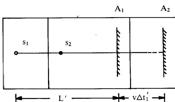
รูปที่ 32 แขนของการทดลองไม่เคลื่อน-มอร์เลย์ ซึ่งนานกับทิศการเคลื่อนที่ของเครื่องมือ
