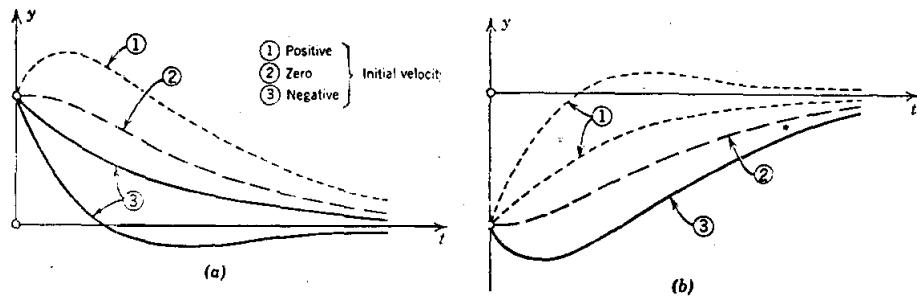
รูป 5.6 ชนิดของการเคลื่อนที่ในกรณี overdamped
