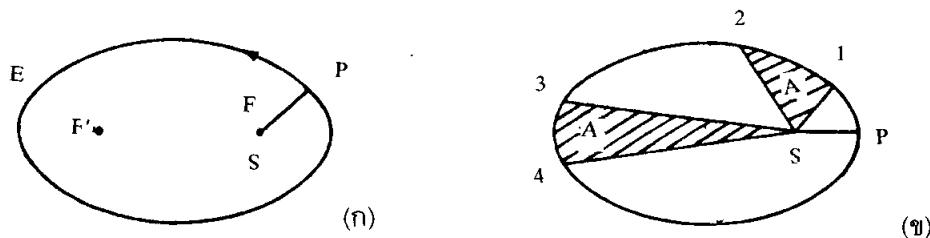
รูป 7.1 กัญชงเคเบลอร์ (ก) แสดงดาวเคราะห์โคจรเป็นวงรีรอบดวงอาทิตย์ซึ่งอยู่ที่จุดโฟกัสจุดหนึ่ง (ข) ในวงโคจรรอบดวงอาทิตย์ดาวเคราะห์จะใช้เวลาเคลื่อนที่ระหว่างจุด 1 ถึงจุด 2 เท่ากับเวลาที่ใช้เคลื่อนที่จากจุด 3 ไปจุด 4 โดยการดัชนี้ที่ไปเท่ากันทั้งสองช่วง
