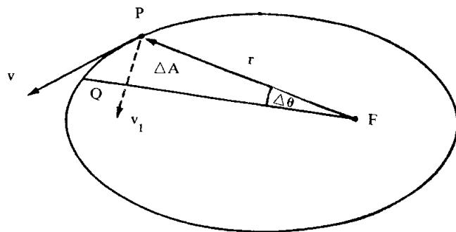
รูป 7.3 แสดงกฎของพื้นที่ วัตถุที่ต่ำแห่ง P จะมีระย่างห่างจากดาวอาทิตย์เป็น  $r$  กำลังเคลื่อนที่ด้วยความเร็ว  $v$  ไปยังจุด Q เมื่อเวลา  $\Delta t$  ในขณะที่เส้นรัศมีภาคพื้นที่ไป  $\Delta A$  และมีองค์ประกอบความเร็วตั้งฉากกับ  $r$  เป็น  $v_t$
