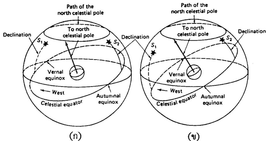
รูปที่ 3.11 การหมุนควงของแกนหมุนของโลกมีผลทำให้ค่าพิกัดของเทห์ฟากฟ้าในระบบพิกัดเส้นศูนย์สูตรมีการเปลี่ยนแปลง
