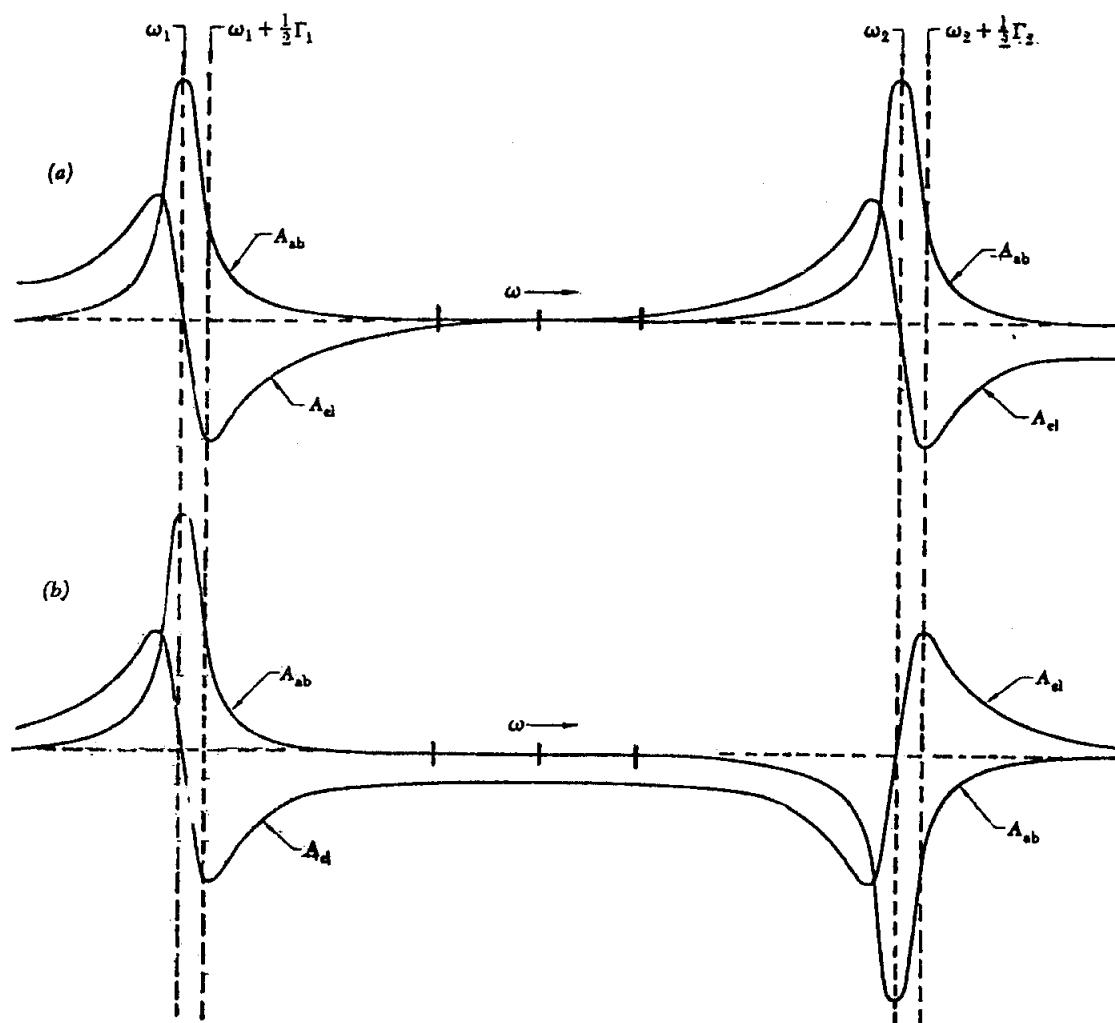
รูป ๑.๔ แสดงการเกิดภänาทในระบบสองส่องสีกึ่งอิเล็กตรอน plot มันปฏิจุก absorptive และ elastic กับ ความถี่
