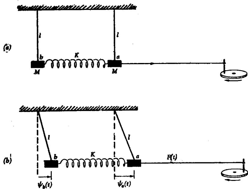
รูป ๗.๗ การอອกรชีด เลขอของระบบสูงต่ำควบคู่
