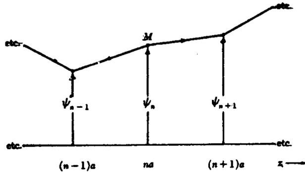
รูป ๒.๑๑ แสดงลักษณะของเส้นเชือกลูกบิดสำหรับการออสซิลเลตตามขวางทาง  $x$
