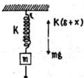
สำหรับการถอดเส้น เส้นความแนวน้ำที่ แรงที่กระทำ ต่อมวล  $m$  มีสองแรงคือ แรงเป็นของจากสปริง  $K(\delta + x)$  และเป็นของจากน้ำหนัก  $mg$  ของมวล ดังที่แสดงการถอดของการเคลื่อนที่คือ
