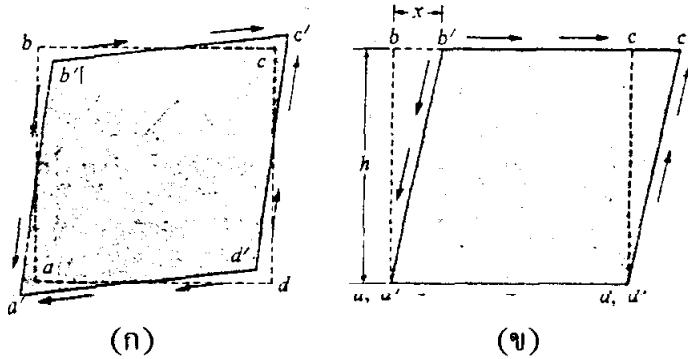
รูปที่ 7.5 การเปลี่ยนรูปทรงของวัตถุด้วยแรงเฉือน โดยความเครียดเฉือนเท่ากับ  $x/h$ .
