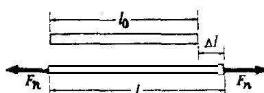
รูปที่ 7.4 แท่งวัตถุเดิมยาว  $L_0$  เมื่อถูกแรง  $F_h$  ดึงหัวท้ายทำให้ได้ความยาวเพิ่มขึ้นเป็น  $L$  การยืดออกเป็นไปตลอดแห่ง ไม่ใช่ยืดออกที่หัวและท้ายเท่านั้น
