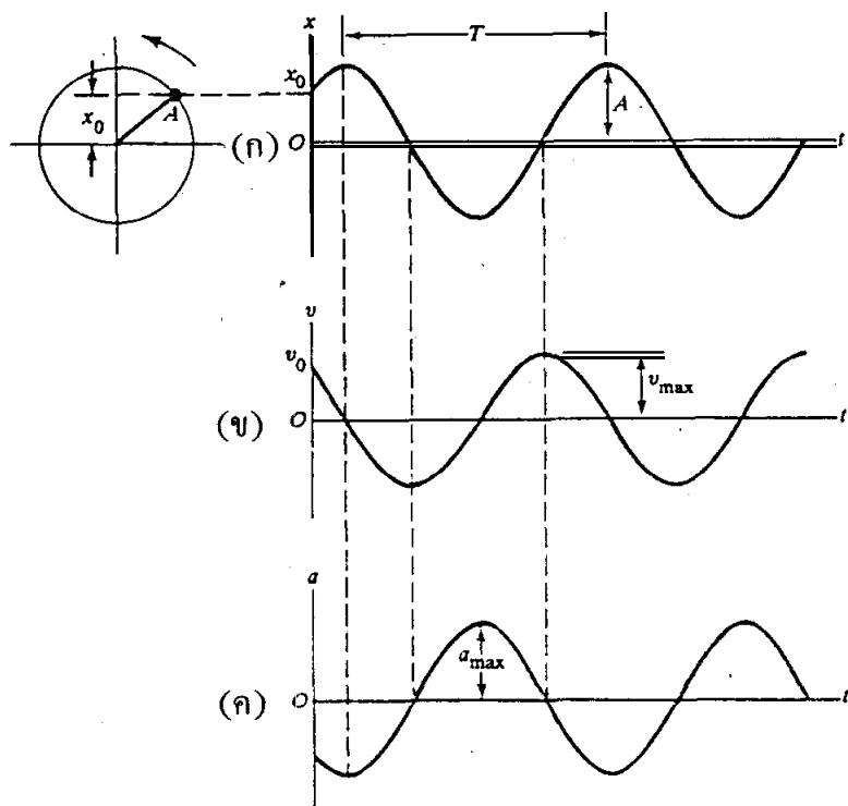
รูปที่ 7.8 แสดงความสัมพันธ์ของระยะกระชั้ด ความเร็ว และความเร่ง เมื่อยกเทียบ กับเวลา ของการเคลื่อนที่手臂อนิ哥ย่างง่าย (SHM)
