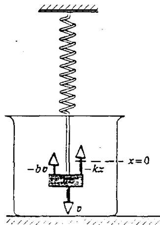
รูปที่ 7.20 ตัวอย่างหนึ่งของการออสซิลเลตแบบหน่วงคือ เมื่อวัดถูกเคลื่อนที่ในของเหลว
