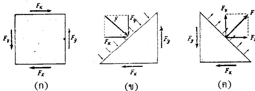
รูปที่ 7.2 (ก) วัตถุกำลังดูกรงเพื่อน (shear) (ข) ความเก็บดามเส้นทแยงมุมเป็น
