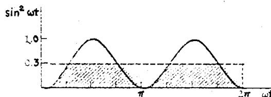
รูปที่ 7.22 กราฟของ  $\sin^2 \omega t$  ในหนึ่งรอบ ค่าเฉลี่ยคือ  $\frac{1}{2}$
