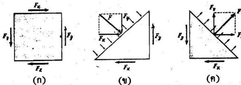
รูปที่ 7.2 (ก) วัตถุกำลังถูกแรงเฉือน (shear) (ข) ความเค้นตามเส้นทแยงมุมเป็นความเค้นอัด (ค) ตามอีกเส้นหนึ่งเป็นความเค้นดึง
