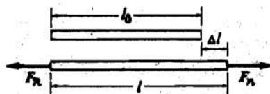
รูปที่ 7.4 แท่งวัตถุเดิมยาว  $L_0$  เมื่อถูกแรง  $F_n$  ดึงหัวท้ายทำให้ได้ความยาวเพิ่มขึ้นเป็น  $L$  การยืดออกเป็นไปตลอดแท่ง ไม่ใช่ยืดออกที่หัวและท้ายเท่านั้น ความเครียดเฉือนทำให้รูปร่างของวัตถุเปลี่ยนแปลงไปดังรูปที่ 7.5
