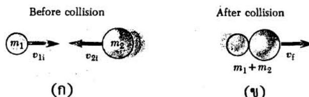
รูปที่ 5.17 การชนแบบไม่มีอิทธิพลของแรงต้านระหว่างสองอุปกรณ์ห้องชนกัน
