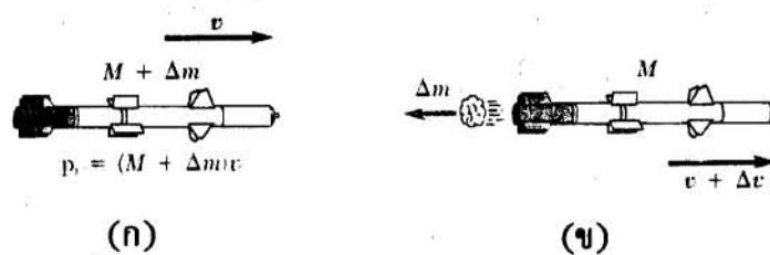
รูปที่ 5.27 การขับเคลื่อนจรวด
