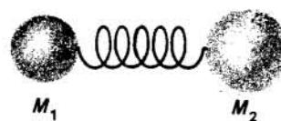
รูปที่ 5.1 ระบบอนุภาคประกอบด้วยมวล 1 และมวล 2 เชื่อมต่อเข้าด้วยกันโดยสายปริ่งเบา
