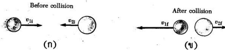
รูปที่ 5.21 การชนแบบบีดหยุ่นสมบูรณ์ระหว่างสองอนุภาค พุ่งชนกันโดยตรง (a) ก่อนชน และ (b) หลังชน
