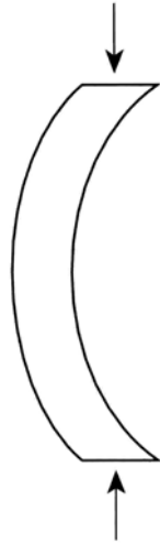
รูปที่ 9.1 การเสียรูปแบบโค้งงอออกด้านข้างของวัสดุภายใต้แรงอัด
