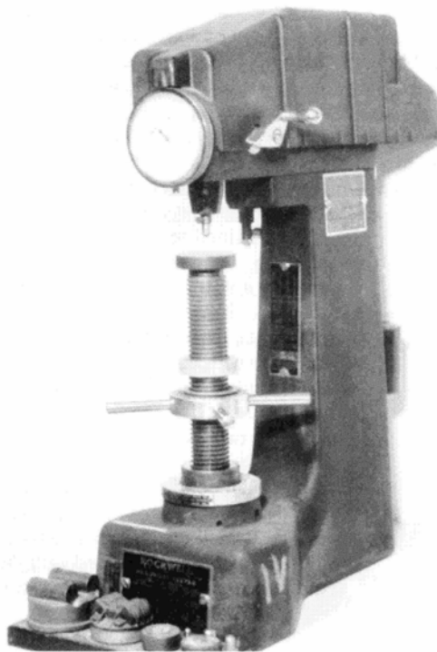
รูปที่ 7.3 เครื่องทดสอบความแข็งแบบ Rockwell พร้อมหัวกด
