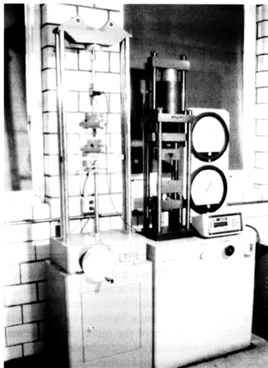
รูปที่ 5.2 เครื่องทดสอบอเนกประสงค์ (Universal testing machines)
