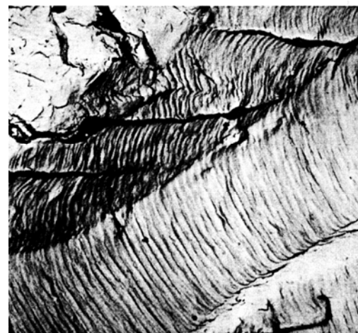
รูปที่ 13.2 พื้นผิวเรียบจากการขัดสีของรอยแตกเริ่มต้น
