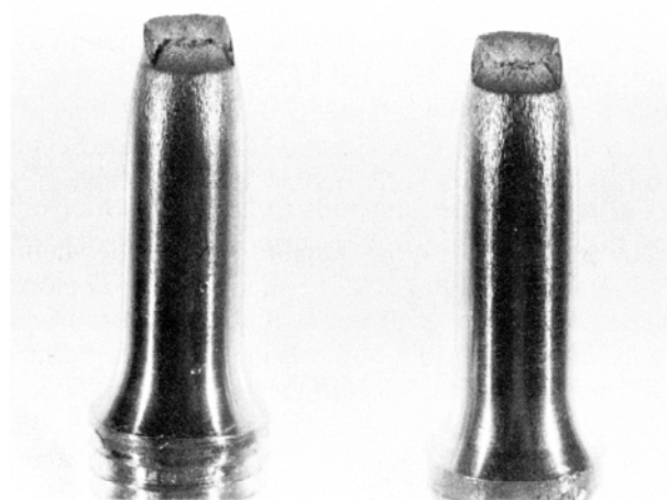
รูปที่ 1.37 รอยแตกเหนียวแบบถ้วยกับกรวย (cup and cone) ของโลหะผสมอะลูมิเนียม
