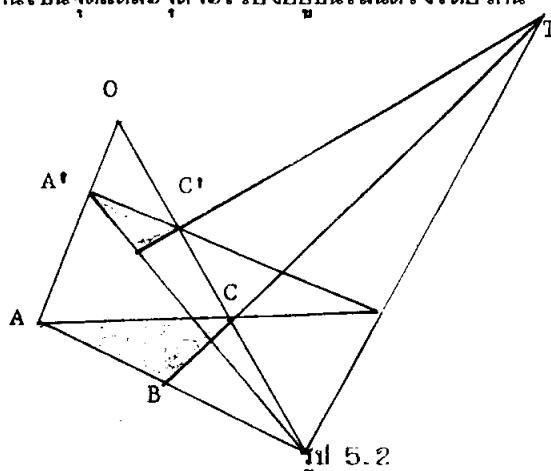
เราอาจพิจารณาว่ารูปสามเหลี่ยม  $ABC$  และรูปสามเหลี่ยม  $A'B'C'$  เป็นภาคตัดที่ต่างกันของภารณาที่มีรูปสามเหลี่ยมที่สามเท่าได้ ได้ที่  $OAA'$ ,  $OBB'$ ,  $OCC'$  เป็นเส้นของภารณา (Line of Projection) ของรูปสามเหลี่ยมทั้งสามจากจุด  $O$  และบนภารณาที่สามเหลี่ยมทั้งสองตามที่กล่าวมานี้จะอยู่บนภารณา แต่ถ้าหากอยู่บนภารณาเดียวกัน ทฤษฎีของเดชาร์กส์ยังคงเป็นจริงด้วยแต่การพิสูจน์ต้องสองกรณีสูญนั่นต่างกัน
