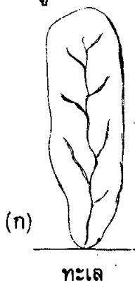
รูปที่ 7.1 ลักษณะของพื้นที่ลุ่มน้ำ (ก) ลุ่มน้ำรูปขนนก (ข) ลุ่มน้ำรูปวงกลม (ค) ลุ่มน้ำรูปขนาน
