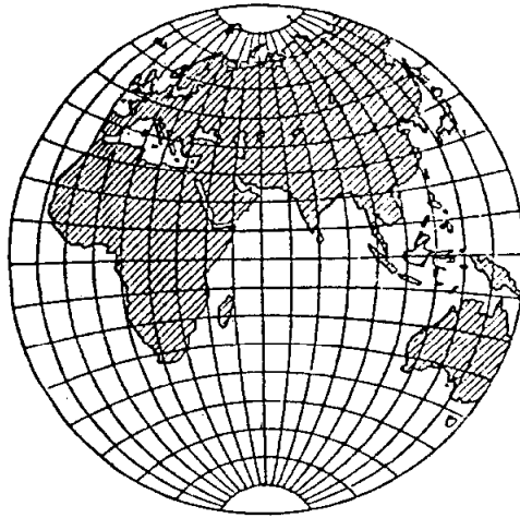
รูปที่ 4.33 เส้นโครงแผนที่แบบดลูกโลก มีเมริเดียนย่านกลางและเส้นศูนย์สูตรตัดกันเป็นเส้นตรง
