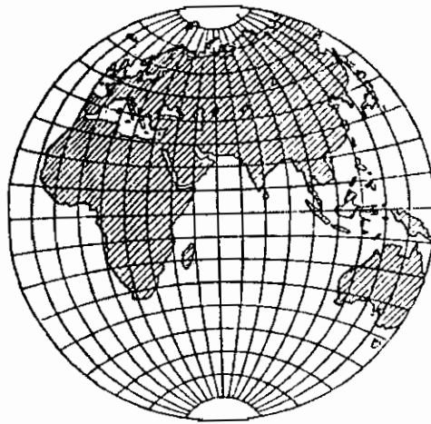
รูปที่ 4.33 เส้นโครงแผนที่แบบลูกโลก มีเมริเดียนย่านกลางและเส้นศูนย์สูตรตัดกันเป็นเส้นตรง
