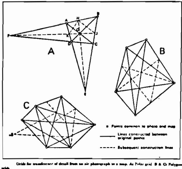
รูปที่ 10.7 การถ่ายทอดรายละเอียดด้วยวิธีเส้นกริดจากภาพถ่ายทางอากาศลงบนแผนที่ A) แบบ Polar grid, B และ C) แบบ Polygonal grids.
