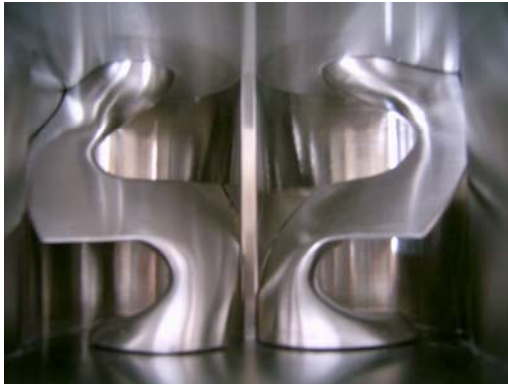
ภาพที่ 8.2 แกนผสมรูปตัว Z ในเครื่องฟารีโนกราฟ
