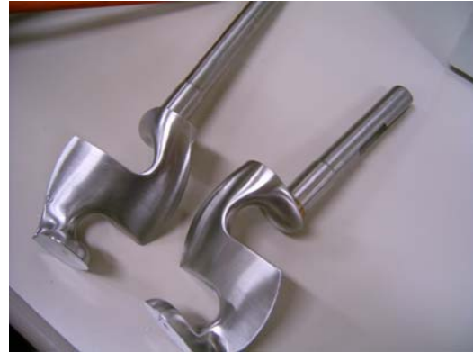
ภาพที่ 8.2 แกนผสมรูปตัว Z ในเครื่องฟารีโนกราฟ
