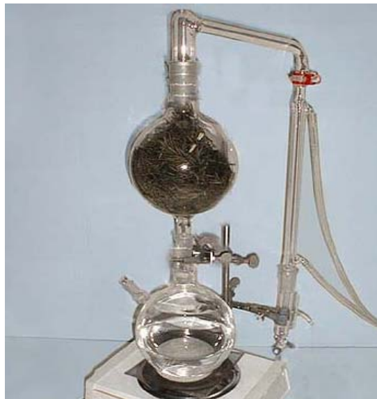
ภาพที่ 7.2 การสกัดน้ำมันหอมระเหยโดยวิธีการกลั่นโดยใช้ไอน้ำ
