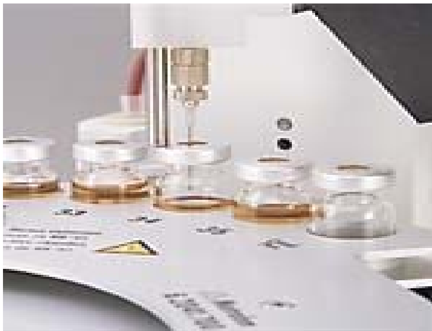
ภาพที่ 3.13 การเก็บตัวอย่างเพื่อวิเคราะห์โดยใช้ Auto-sample headspace analysis
