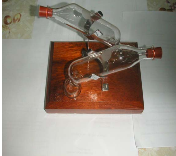
ภาพที่ 9.1 Mojonnier Apparatus (ชุดวิเคราะห์ปริมาณไขมันในอาหาร)
