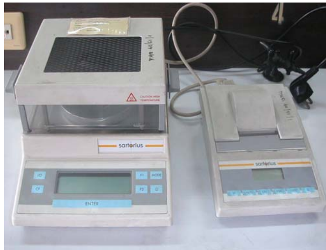
ภาพที่ 7.2 เครื่องวิเคราะห์ความชื้นแบบอินฟาเรด
