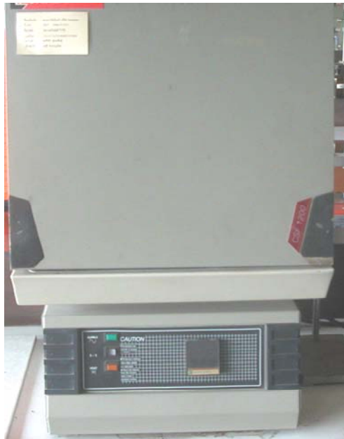
ภาพที่ 8.1 เตาเผาตัวอย่างอาหาร (muffle furnace)
