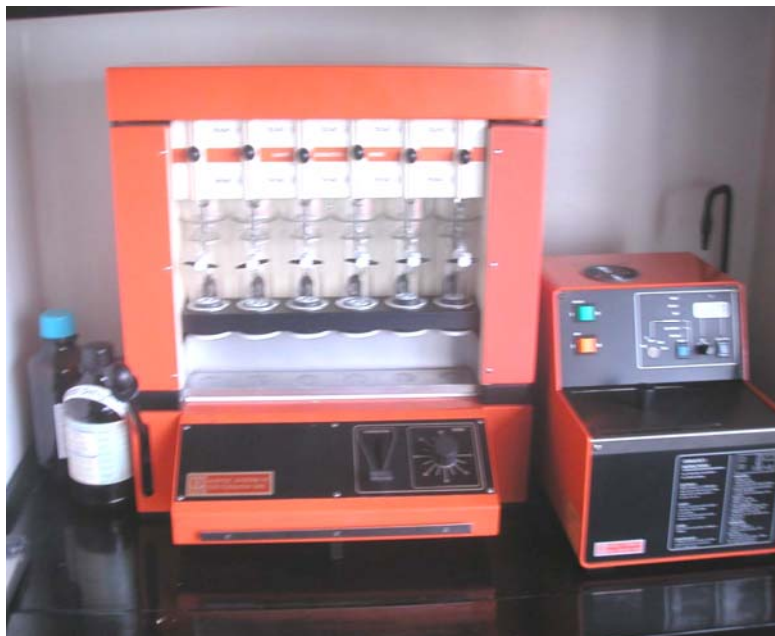
ภาพที่ 11.1 เครื่องวิเคราะห์ไขมัน (Soxhlet Apparatus)
