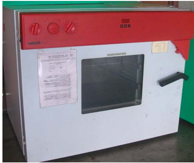
ภาพที่ 7.1 เครื่องวิเคราะห์ความชื้น (Hot Air Oven)
