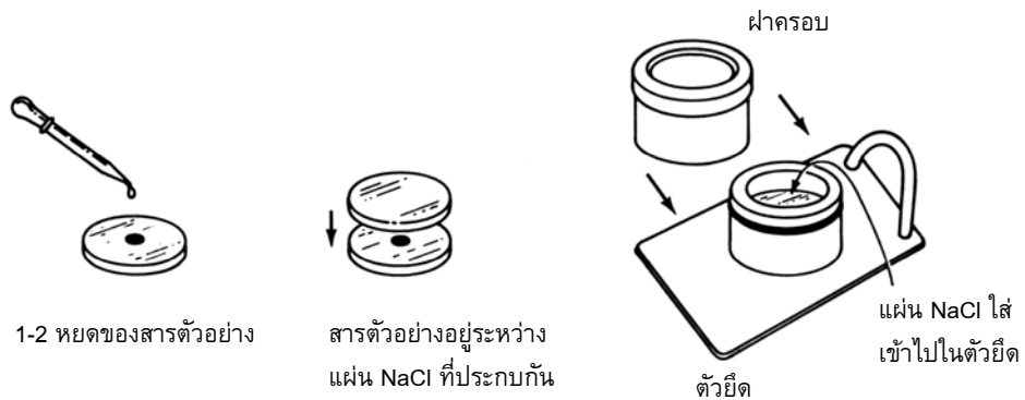
รูปที่ 10.8 การเตรียมสารตัวอย่างของเหลวโดยเตรียมเป็น thin-film
