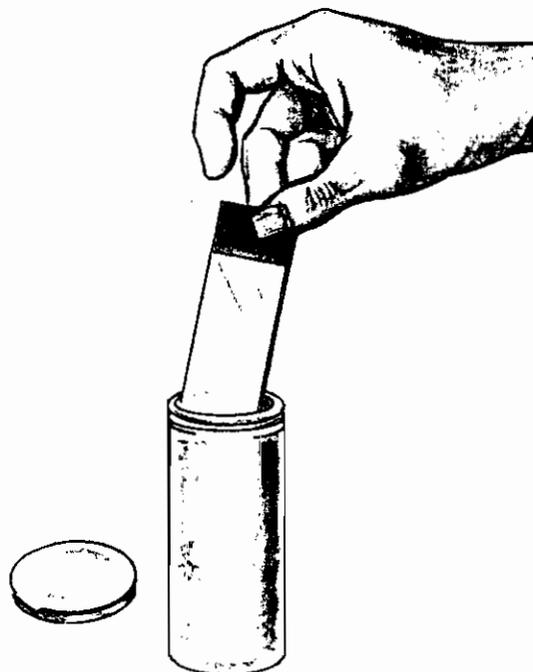
รูปที่ 10.2 การจุ่มแผ่นสไลด์ลงใน slurry
