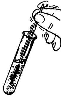
การล้างตะกอน เดิม น้ำ คน เช่นตริพิวก็อีกครึ่ง ทิ้งน้ำล้างตะกอน รูปที่ 11.3 การล้างตะกอนที่ได้จากเครื่องหมุนเหวี่ยง
