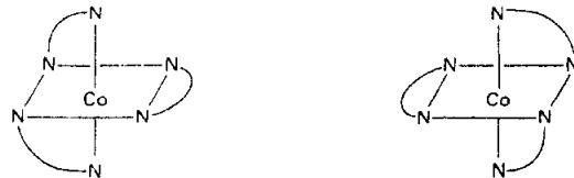
รูปที่ 4.12 Optical isomer ของอ่อนเชิงซ้อน  $[\text{Co}(\text{en})_3]^{3+}$
