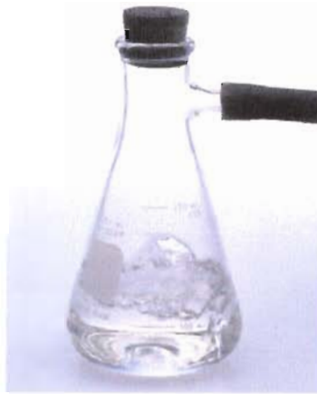
รูปที่ 8.6 การลดความดันของน้ำในขวดรูปกรวย สามารถทำให้น้ำเดือดได้
