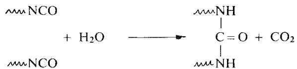
เพราะฉะนั้นในของผสมจะใส่ได้ไอโซไซยาเนต พลีออล และน้ำลงไปพร้อมกัน โพลีออลที่ใช้มักใช้โพลีอีสเทอร์และโพลีอีเชอร์ กระบวนการเตรียมโพเมชนิดยีดหยุ่นที่ใช้ทั้ง ๓ แบบ คือ one-shot, prepolymer และ quasi-prepolymer กรณีที่ใช้โพลีอีสเทอร์ มีนิยมแบบ one-shot แต่โพลีอีเชอร์นิยมใช้ทั้ง ๓ แบบ
