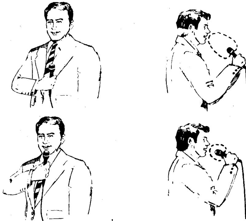
ภาพที่ 33 แสดงตำแหน่งของไมโครโฟน
